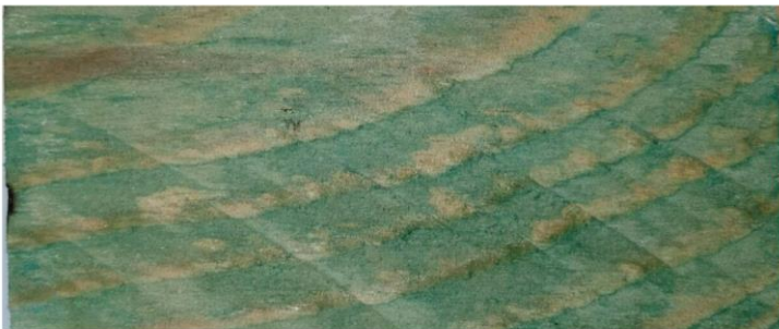
Tűzgátlóval és gomba, rovarölőszerezrel impregnált fenyőléc
